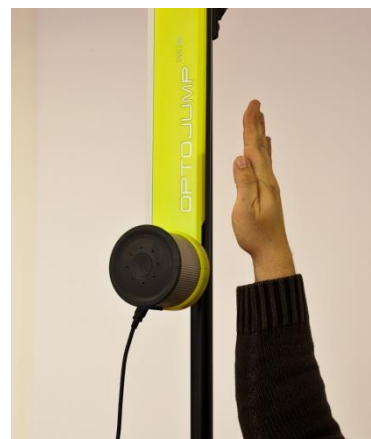
Figura 139 - Come effettuare la misurazione della propria altezza
