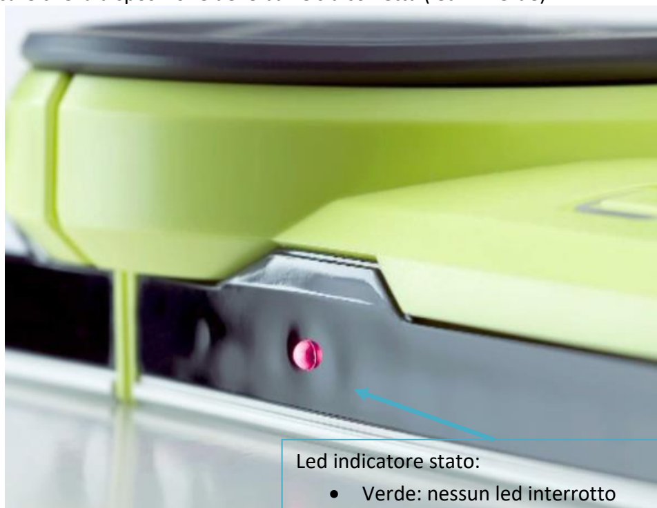
Figura 21 – Led di segnalazione
