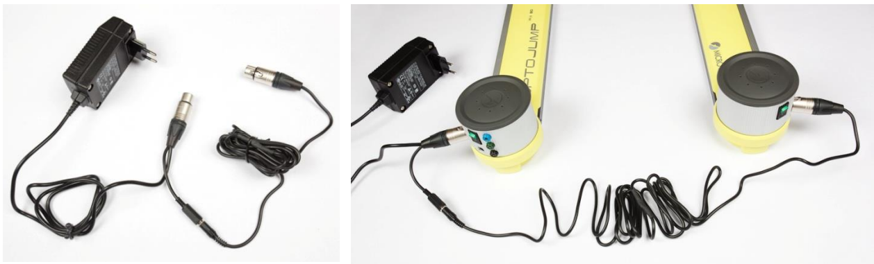
Abb. 25 – Netzteil und Verbindungskabel zum zweiten Turm
