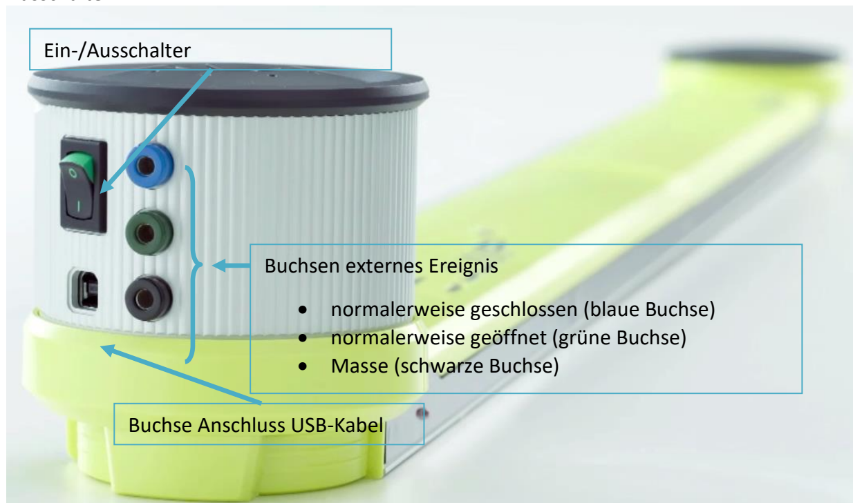
Abb. 10– Balken mit Schnittstelle
