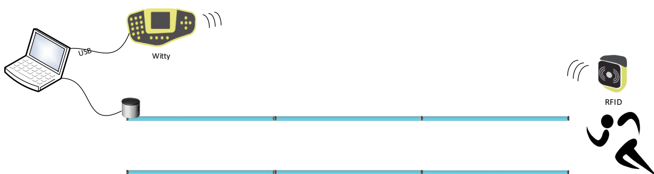
Figura 110 - Witty RFID comunica via radio tramite un Witty Timer attaccato via USB
