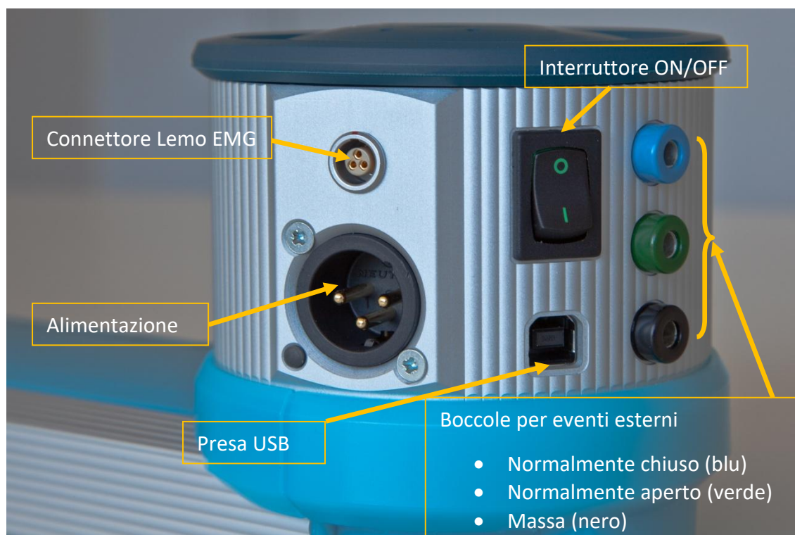
Figura 9 – Barra con interfaccia
