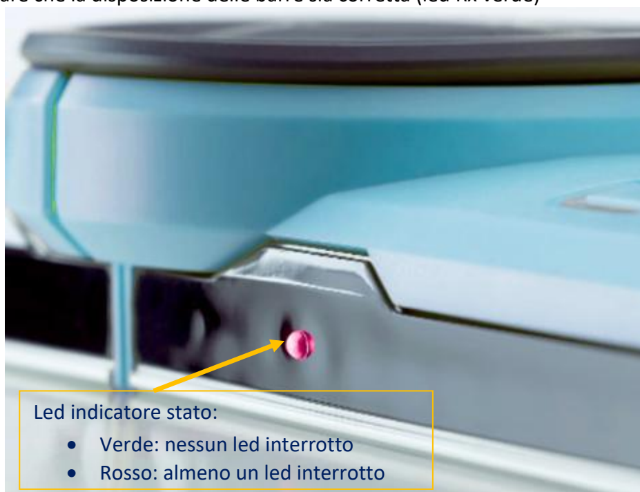
Figura 20 – Led di segnalazione
