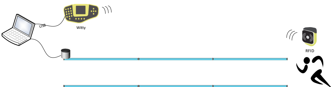
Figura 111 - Witty RFID se comunica vía radio a través de un Witty Timer conectado por cable USB
