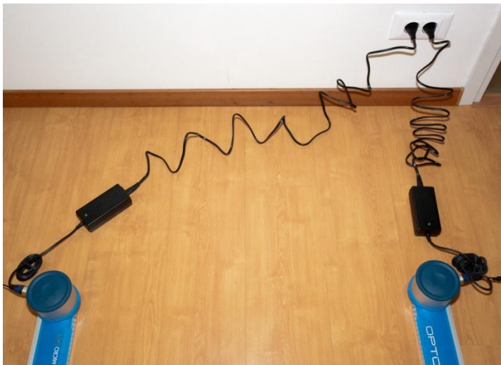
Figura 25- Zwei Netzteile für aus mehreren Metern bestehende lineare Systeme
