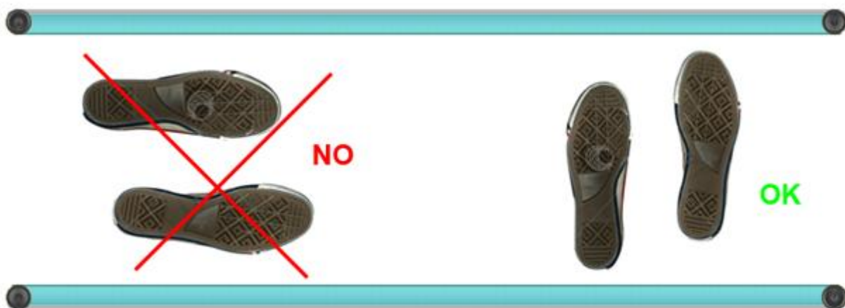
Abb. 52 - richtige Ausführung eines Tapping Tests
