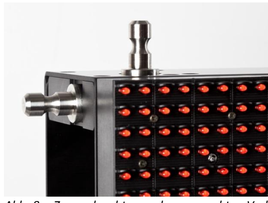
Abb. 8 – Zur senkrechten und waagerechten Verbindung angebrachte Stifte
