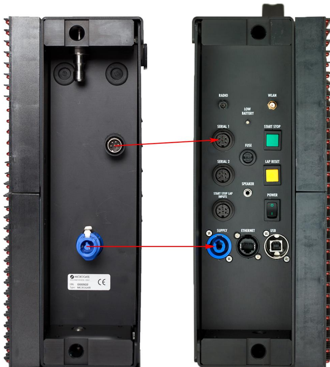
Abb. 10 - Anschluss für Stromversorgung und Datenverbindung
