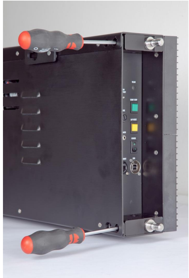
Abb. 12 – Befestigung an der Außenseite
